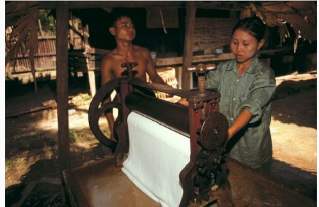
Abbildung 12: Pressen zur Herstellung von Sheet-Latex
