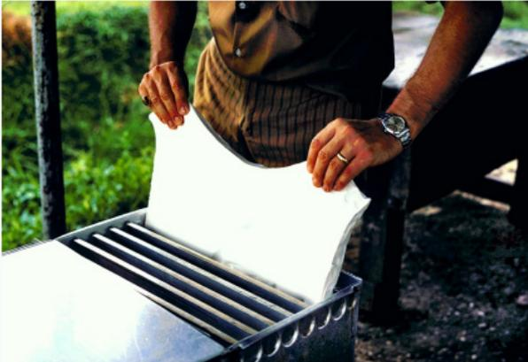
Abbildung 11: Koagulation mithilfe von Ameisensäure
